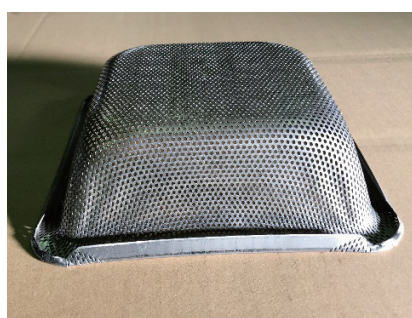
④サーボプレス 端部立上げ(鋭角折り込み)
