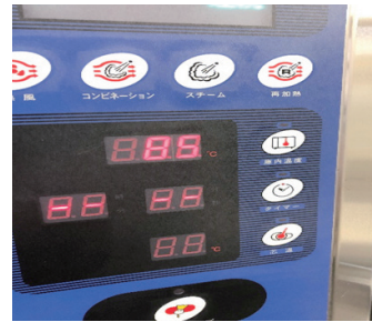
スチームコンベクションによる温度管理
