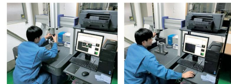
3次元測定機を用いた測定作業の様子
