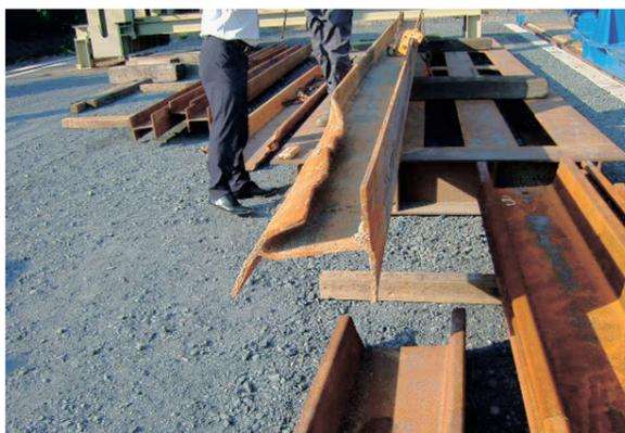
先端部が変形し、再使用不可能なH形鋼
