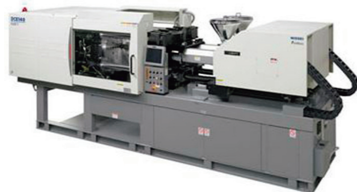
3色成形機 《型締力250t 2色電気式射出成形機+単独射出ユニットの組み合わせ》
