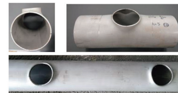
本事業で試作したバーリング加工による分岐配管
