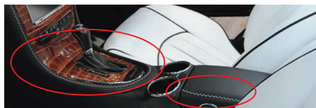
特殊マシンを使用しての斬新な縫い目による加飾ステッチ縫製
