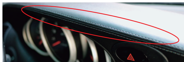
一般的な本縫い目による加飾ステッチ縫製
