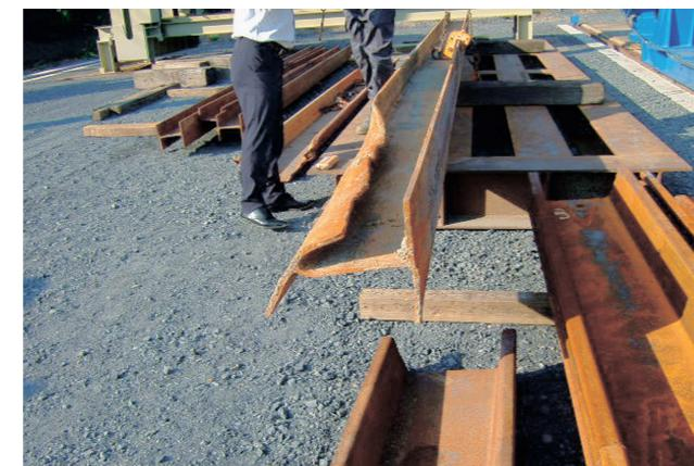
先端部が変形し、再使用不可能なH形鋼
