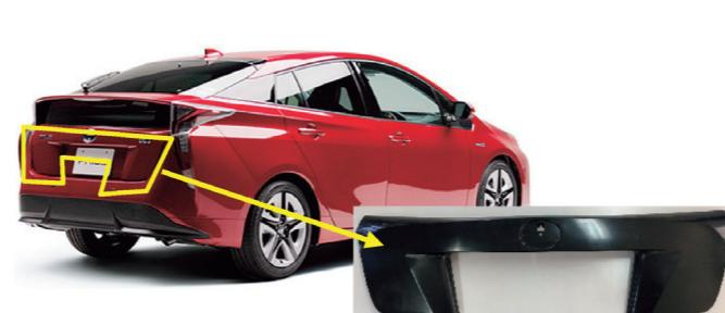
SGウェルドレス成形技術で軽量化したプリウスのバックパネル
