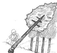
(図5)かかっている木の元玉切り
