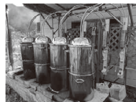
アロマオイルを精製する 蒸留釜
