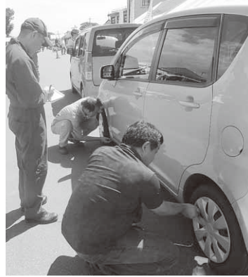
タイヤの点検作業を行う様子
